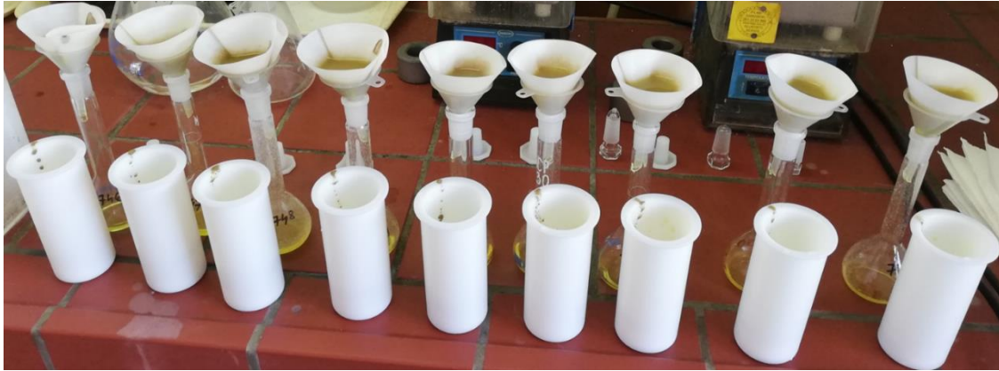
Slika 6. Filtriranje kisele otopine uzorka
