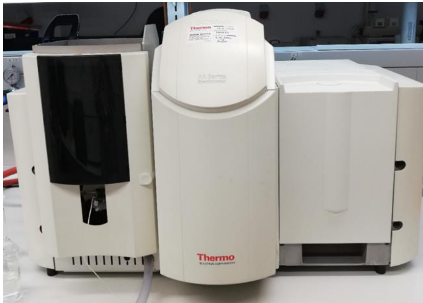
Slika 7. Atomski apsorpcijski spektrofotometar Foto: M. Poljak 2020.
