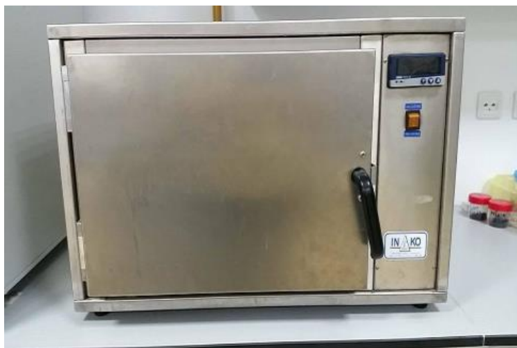
Slika 4. Sušnica za sušenje uzoraka
