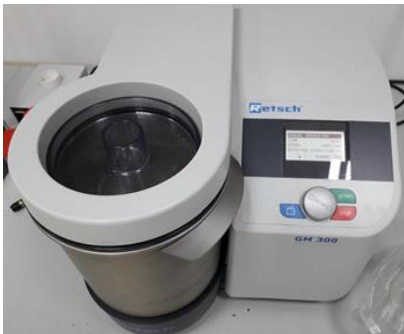
Slika 2. Laboratorijski mlin korišten za usitnjavanje rezidbenih ostataka
