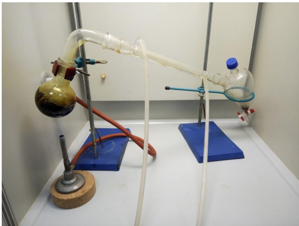
Slika 10. Laboratorijska aparatura za proces pirolize
