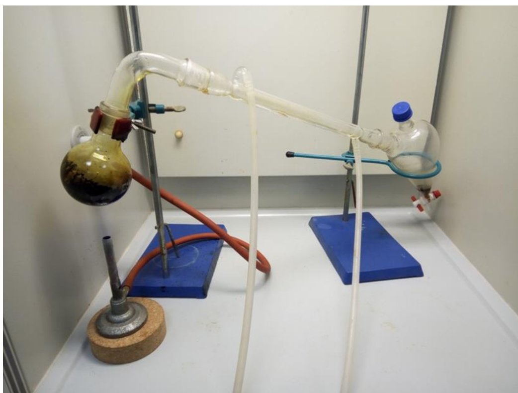
Slika 10. Laboratorijska aparatura za proces pirolize
