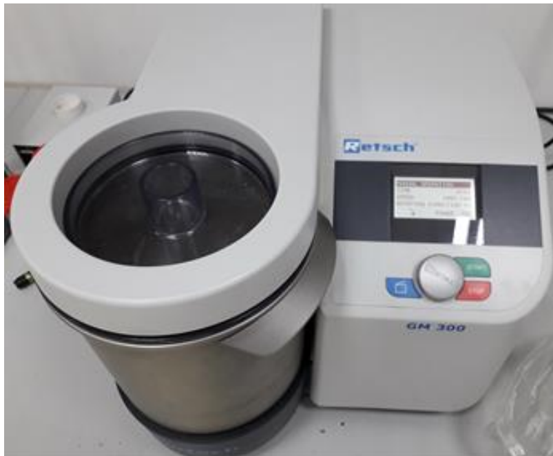
Slika 2. Laboratorijski mlin korišten za usitnjavanje rezidbenih ostataka
