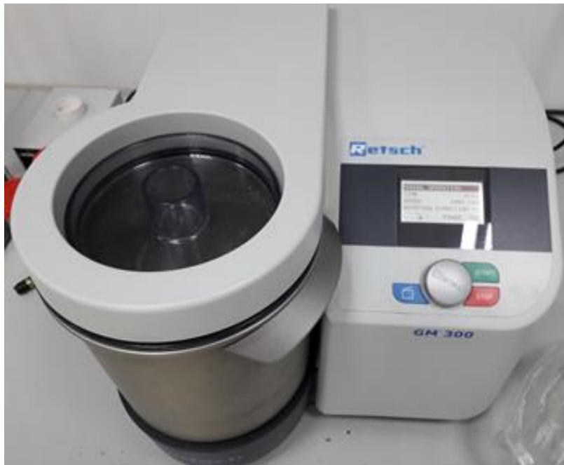
Slika 2. Laboratorijski mlin korišten za usitnjavanje rezidbenih ostataka
