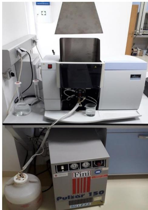
Slika 9. Atomski apsorpcijski spektrometar
