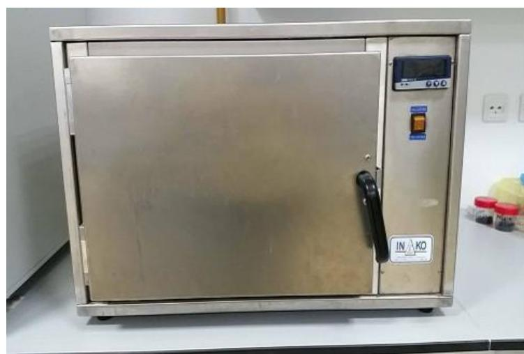
Slika 4. Sušnica za sušenje uzoraka
