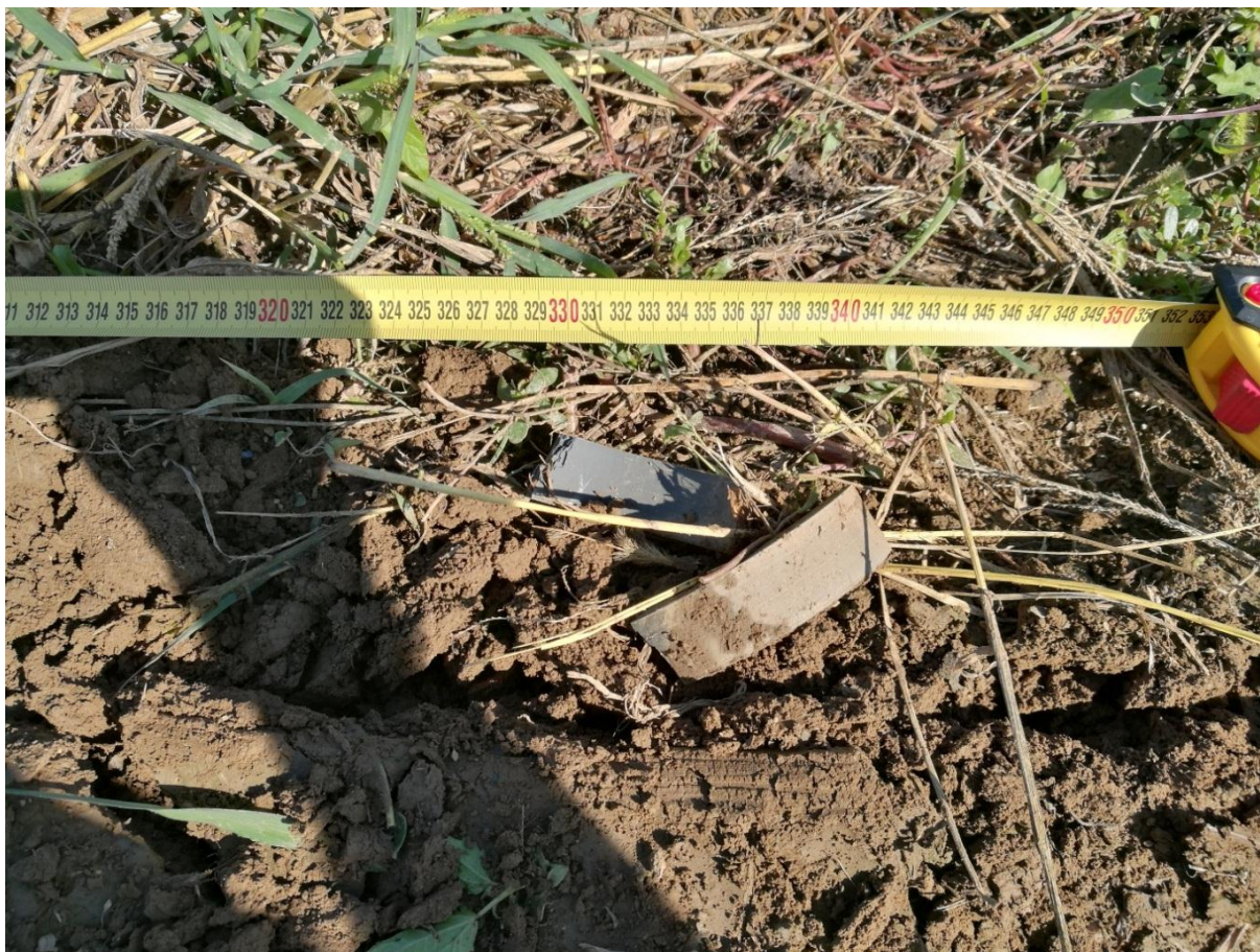
Slika 5.17. Odlomljeni noževi na trećem metru obrade
