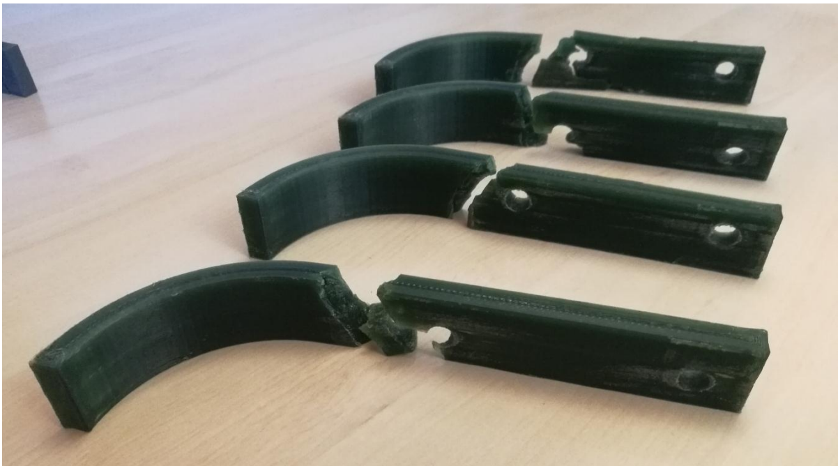
Slika 5.19. Lom PETG noževa
