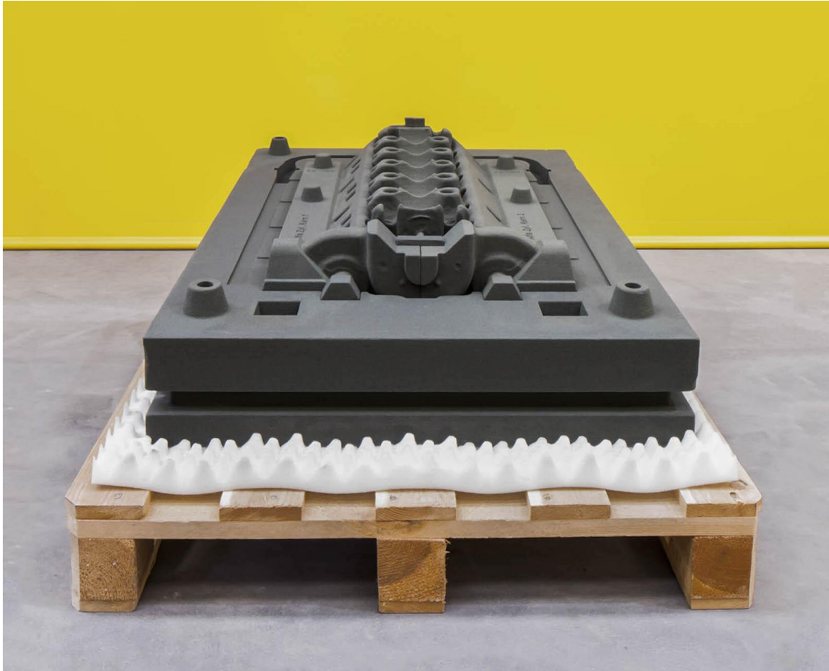
Slika 3.15. Višedjelni pješčani kalup za lijevanje bloka motora nastao SBJ metodom 3D ispisa Izvor: Varotsis ( www.3dhubs.com )
