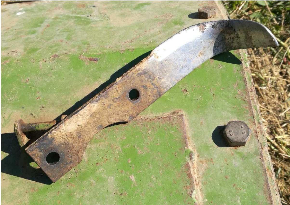
Slika 5.12. Standardni čelični nož debljine 5 mm
