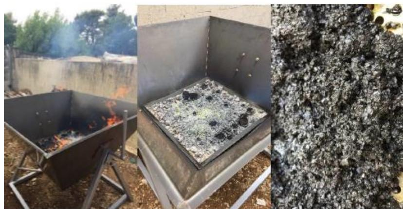
Slika 3.2.2.1. Proces proizvodnje biougljena
