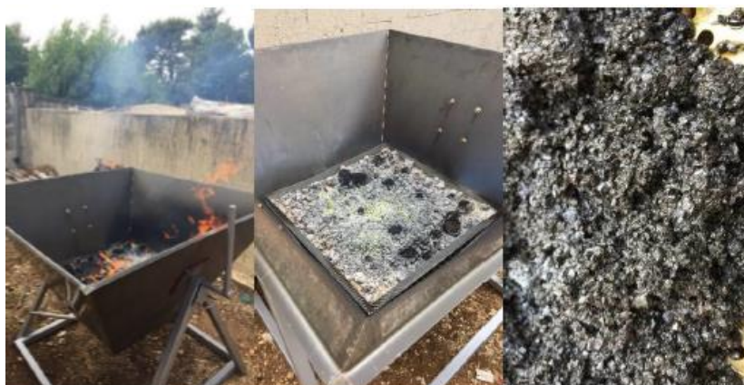
Slika 3.2.2.1. Proces proizvodnje biougljena Izvor: Černe i sur. 2019. (Foto: I. Palčić)
