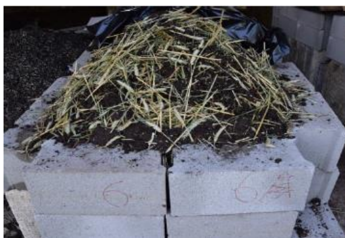
Slika 3.2.1.1. Komunalni mulj pomiješan sa slamom pšenice u komposteru
