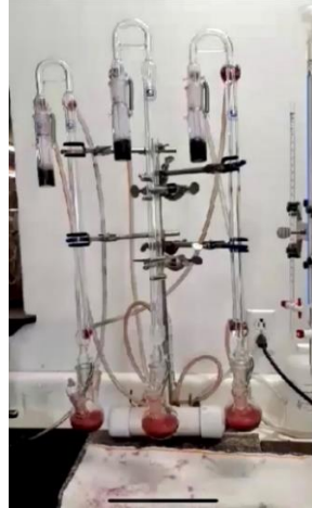
Slika 13: Aparatura za određivanje SO 2 u vinu metodom po Paulu Izvor: Osobni arhiv
