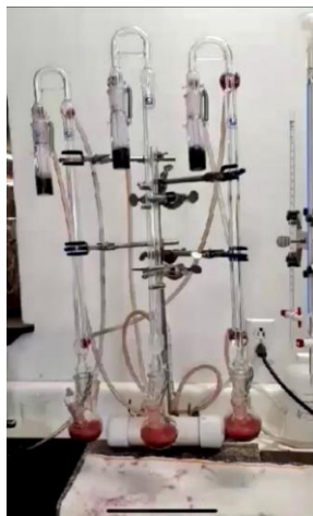
Slika 13: Aparatura za određivanje \text{SO}_2 u vinu metodom po Paulu Izvor: Osobni arhiv
