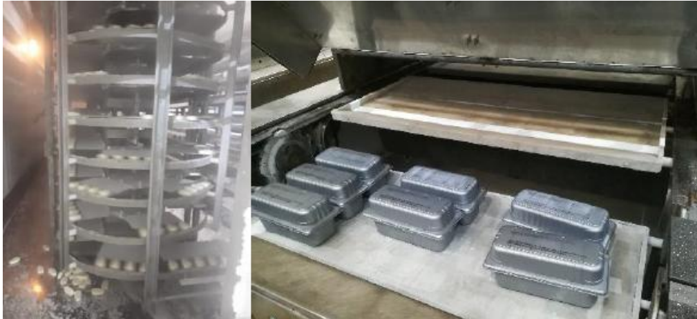
Slika 3.2.2.1. Tuneli za duboko smrzavanje sladoleda
