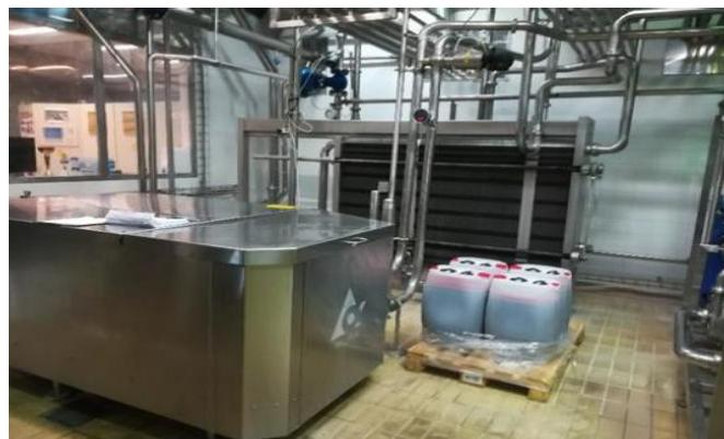
Slika 3.2.1.1 Pasterizator i homogenizator
