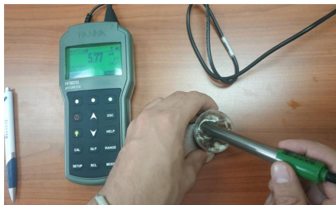
Slika 3.6. Mjerenje pH Izvor: vlastito istraživanje
