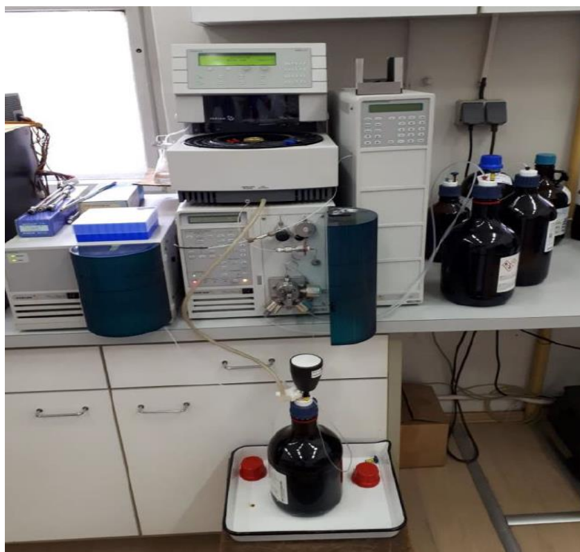
Slika 4.3.1. Varian ProStar 500 HPLC sustav s detektorom s nizom dioda
