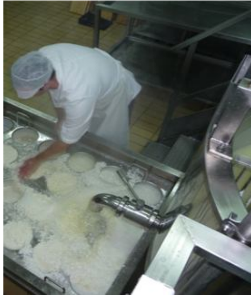
Slika 5. Ispuštanje gruša u kalupe
