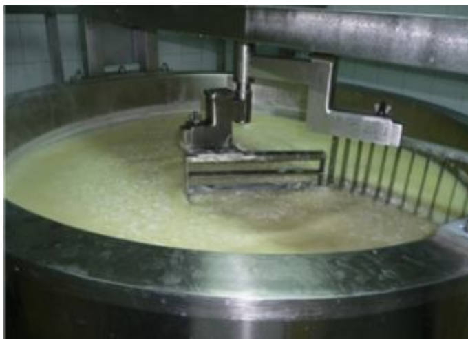
Slika 4. Rezanje sirnoga gruša do veličine zrna pšenice
