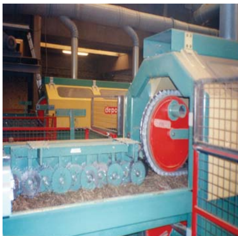
Slika 41. Turbina za razdjeljivanje stabljika lana
