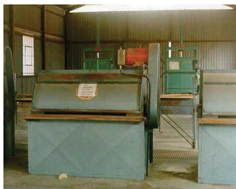
Slika 86 Strojevi za skidanje površinskog sloja listova sisala
