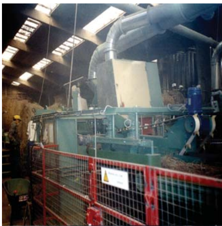
Slika 40. Turbina za odvajanje sjemena od stabljike
