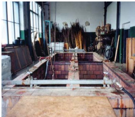
Slika 38. Močenje lana u bazenu s toplom vodom
