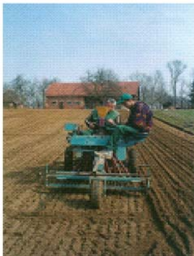
Slika 31. Sjetva lana na pokušalištu samohodnom sijačicom s razmakom među redovima od 10 cm
