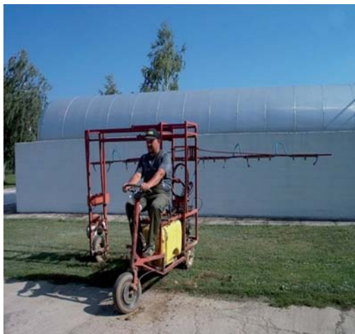
Slika 101. Stroj za prskanje duhana u pokusima
