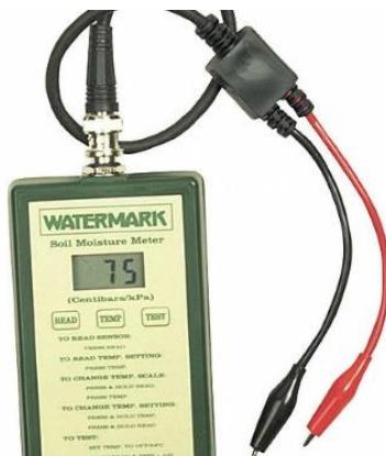
Slika 6.2.2. Mjerni instrument za očitavanje vlage tla
