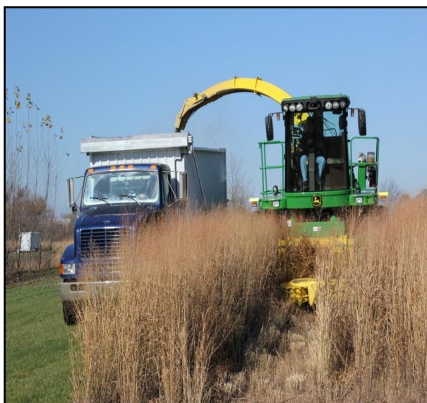
Slika 12. Jednofazna žetva s dva agregata, samokretni krmni kombajn i kamion (Izvor: www.lter.kbs.msu.edu )
