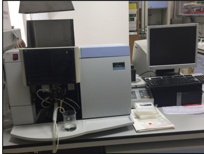
Slika 31. Atomski apsorpcijski spektrometar (Izvor: Božidar Matin - vlastita arhiva)
