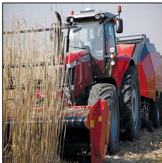
Slika 13. Jednofazna žetva s dva agregata, prednji priključni krmni kombajn i preša (Izvor: www.wnif.co.uk )
