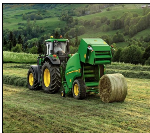
Slika 17. Prešanje okruglih bala (Izvor: www.agriland.ie)
