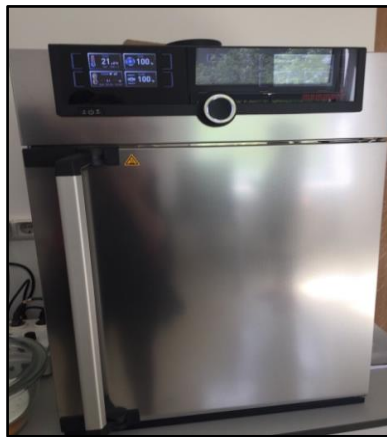
Slika 27. Laboratorijska sušnica (Izvor: Božidar Matin - vlastita arhiva)
