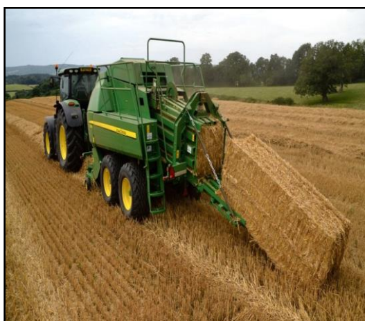
Slika 16. Prešanje četvrtastih bala (Izvor: www.fginsight.com)
