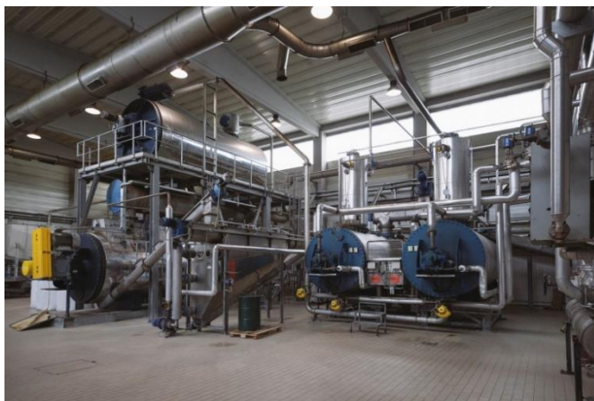
Slika 2.10. Preradbeni dio (sterilizatori, sušara) Izvor: Agroteinika d.d.
