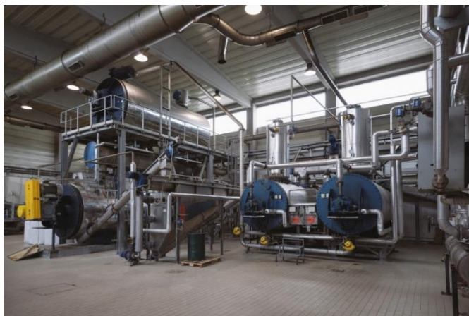
Slika 2.10. Preradbeni dio (sterilizatori, sušara) Izvor: Agroteinika d.d.
