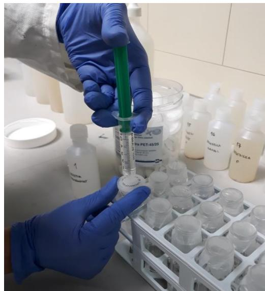
**Slika 4.1.2.** Ubrizgavanje uzorka vode u membranski filter veličine pora  $0,45 \mu\text{m}$
