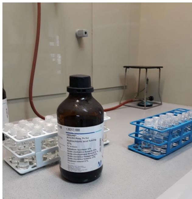
**Slika 4.1.3.** 37%-tna HCl za zakiseljavanje uzorka vode
