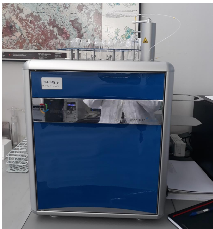
Slika 4.1.4. Uređaj proizvođača Elementar za određivanje TOC-a i DOC-a
