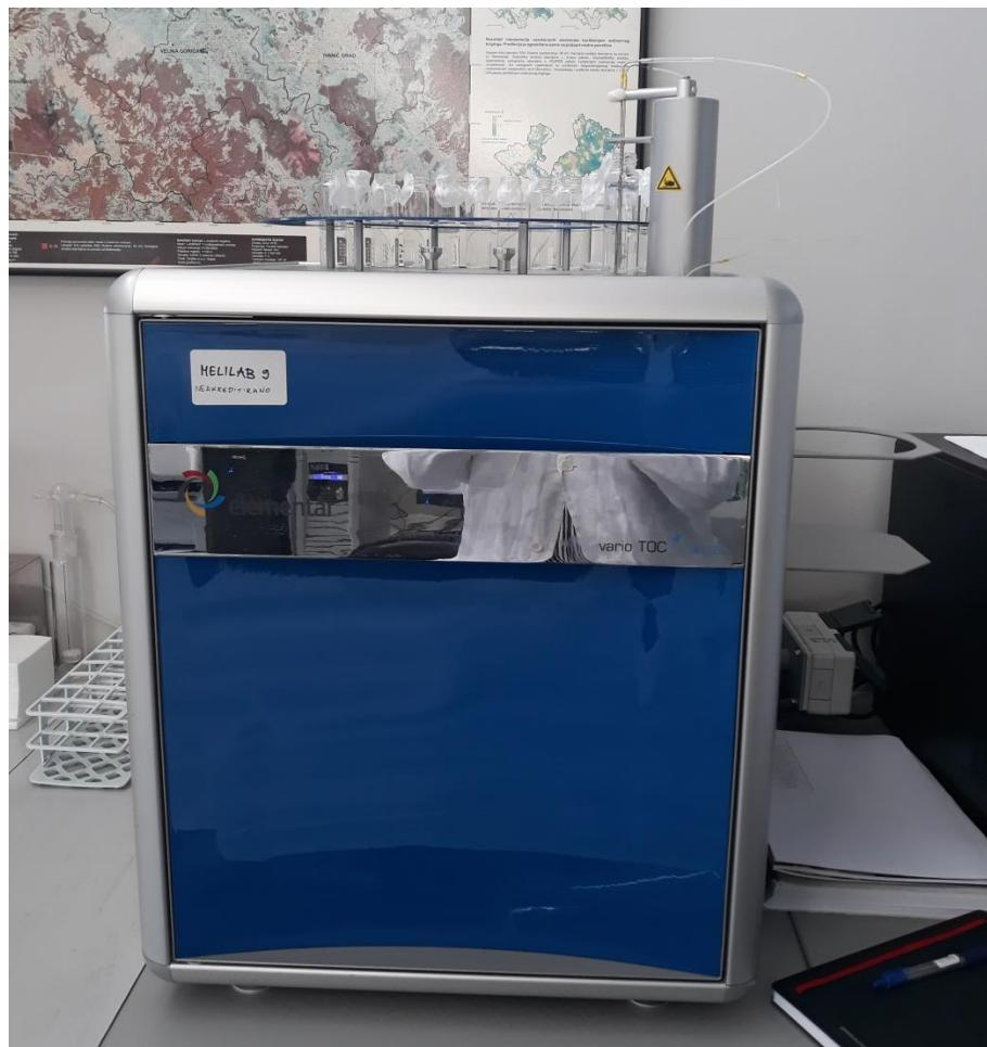
**Slika 4.1.4.** Uredaj proizvođača Elementar za određivanje TOC-a i DOC-a
