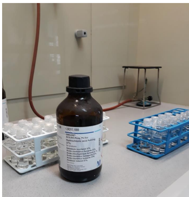
Slika 4.1.3. 37%-tna HCl za zakiseljavanje uzoraka vode
