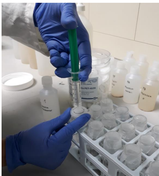
Slika 4.1.2. Ubrizgavanje uzoraka vode u membranski filter veličine pora 0,45 \mu\text{m}
