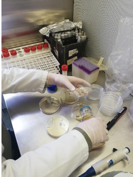
Slika 4.2.3. Prikaz prelijevanja hranjive podloge na razrijeđenu otopinu u Petrijevu zdjelicu
