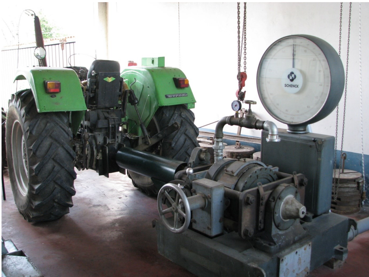
Slika 8. Mjerenje karakteristika motora (Izvor: Goran Fabijanić)
