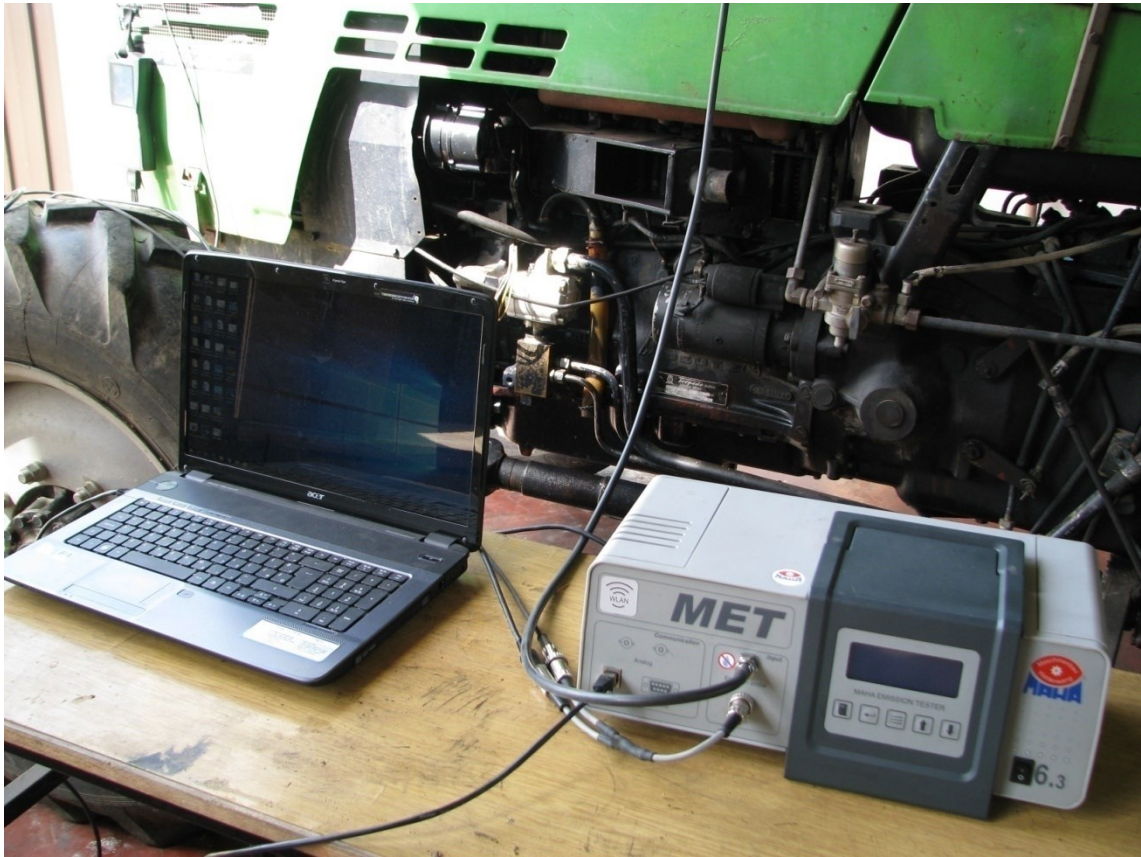
Slika 10. Analizator Maha MET 6.3 (Izvor: Goran Fabijanić)
