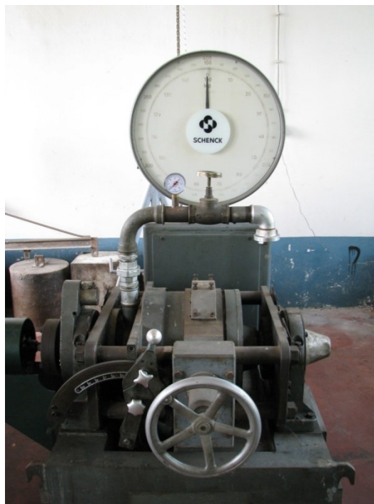
Slika 7. Hidraulična kočnica Schenk tip U1-40 (Izvor: Goran Fabijanić)
