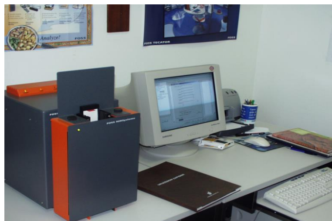
Slika 3.5.3. Skeniranje uzoraka na NIR aparatu (izvor: Marina Vranić)
