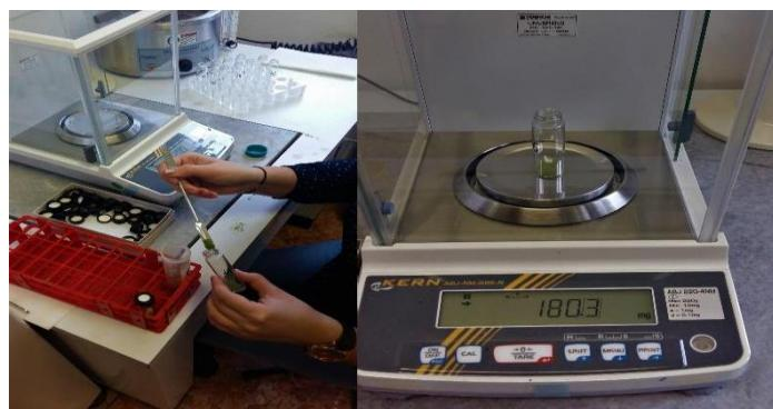
Slika 4.4. Vaganje usitnjenih uzoraka (izvor: M. Žarak)
