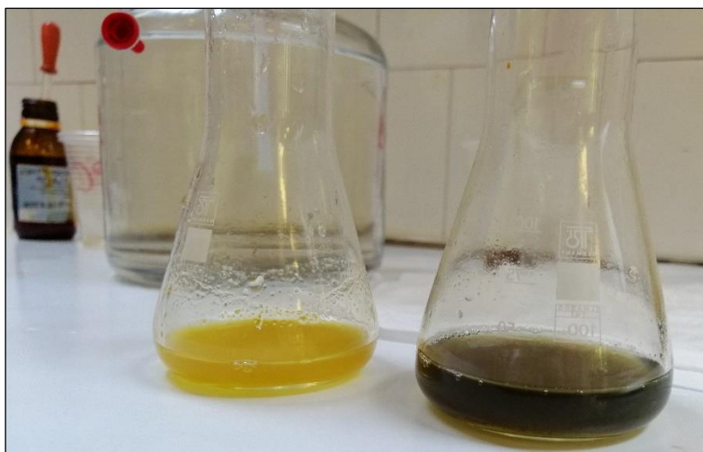
Slika 28. Uzorak mošta prije i poslije direktne titracije i pojava maslinasto zelene boje
