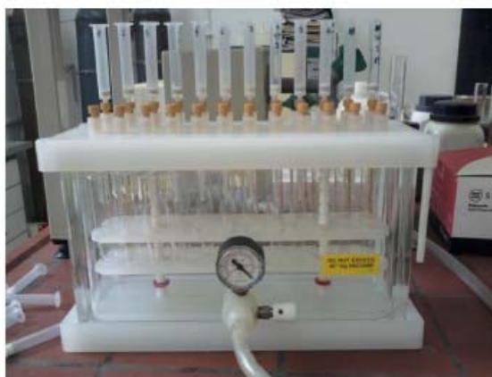
Slika 10. Vakuumski uređaj za ekstrakciju
