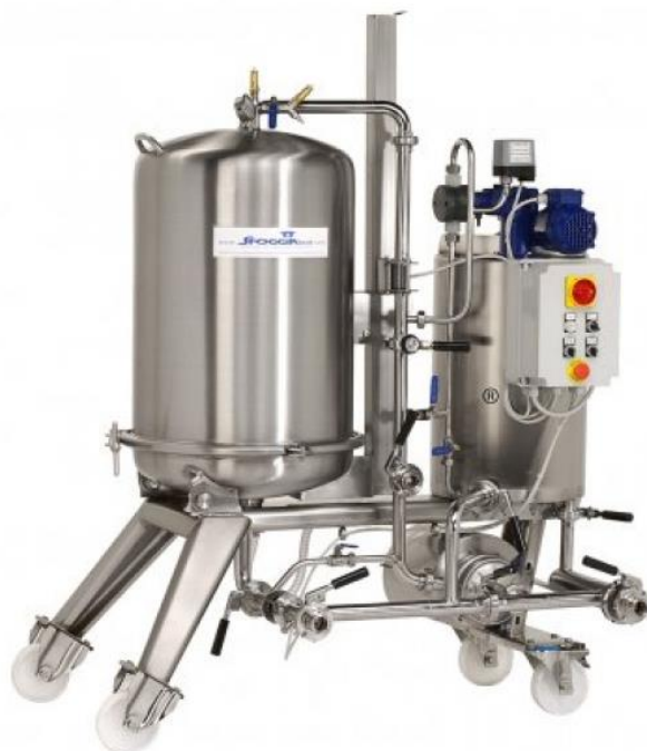
Slika 2.2. Naplavni filter ( http://www.polonainox.com )
