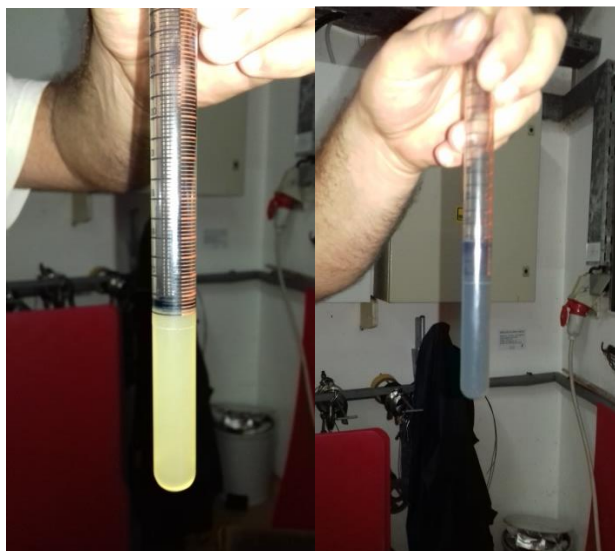
Slika 3.1.1. Mjerenje količine sumpora u vinu (vlastiti izvor)
