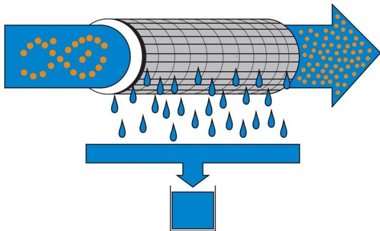
Slika 2.5. Princip rada tangencijalnog filtera
