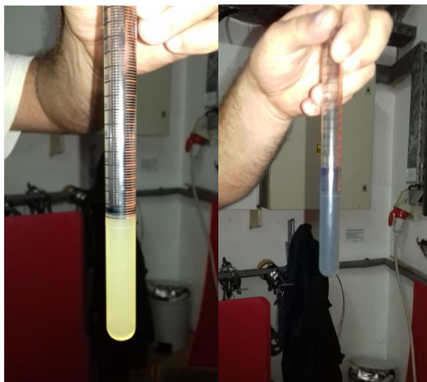
Slika 3.1.1. Mjerenje količine sumpora u vinu (vlastiti izvor)
