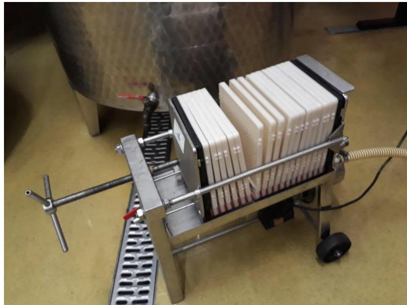
Slika 2.3. Pločasti filter (vlastiti izvor)
