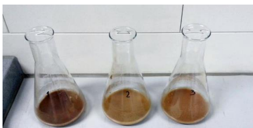
Slika 15. Određivanje sadržaja humusa prema Tjurinu
