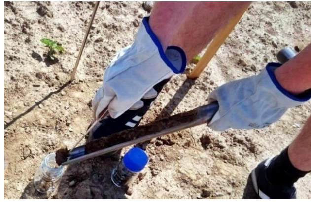
Slika 8. Uzimanje uzoraka tla pedološkom sondom tijekom vegetacije
