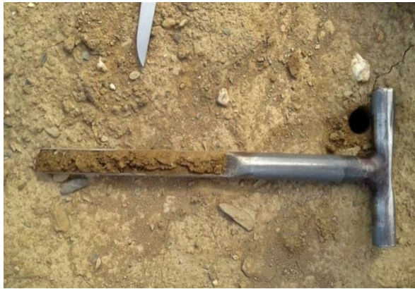
Slika 7. Pedološka sonda za uzorkovanje tla
