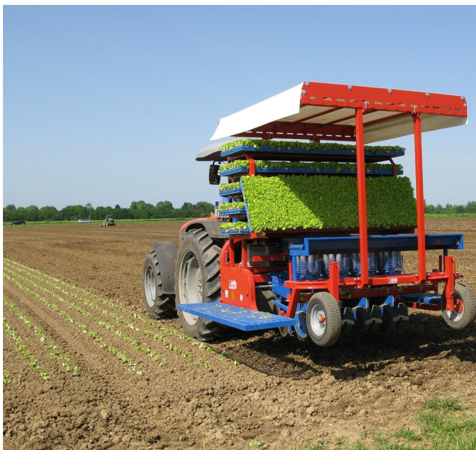
Slika 3.1.1. Četveroredna sadilica (Izvor: A.Vusić)
