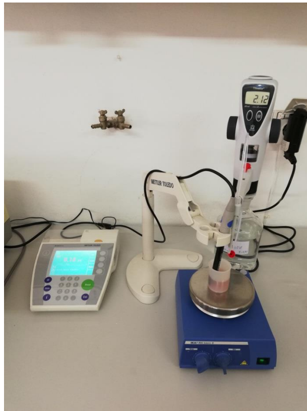
Slika 3.3.3.1. Određivanje pH vrijednosti (Foto: Jasenko, 2019)
