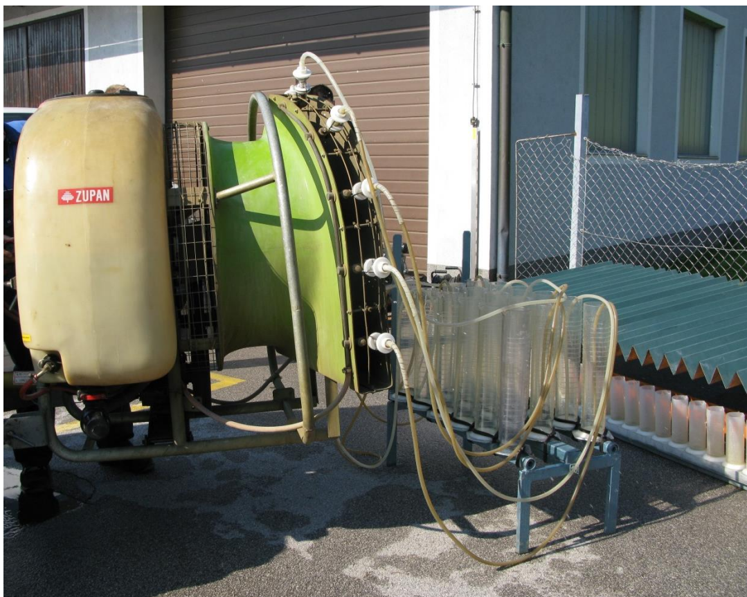
Slika 4.3. Mjerenje protoka mlaznica
