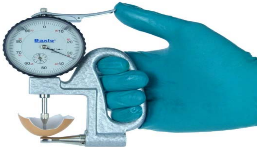
Slika 2.12.3. Mjerač debljine ljuske
