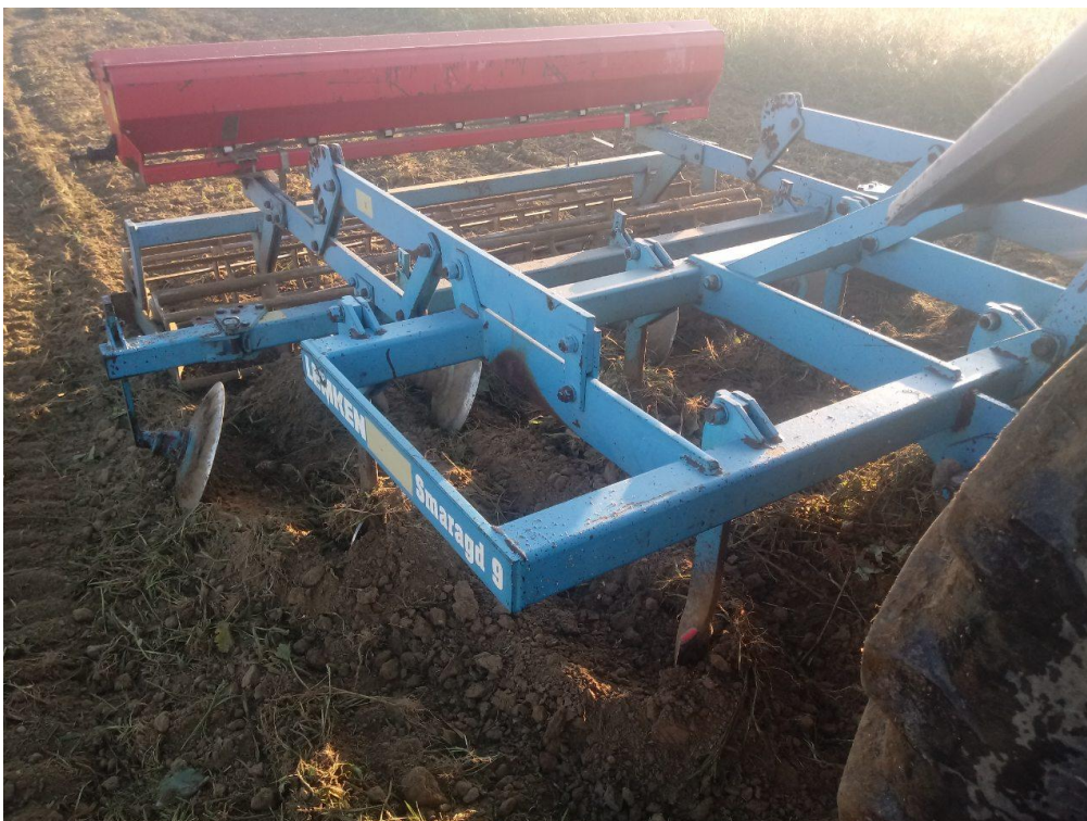
Slika 3.1 Prašenje strništa plošnim kultivatorom
