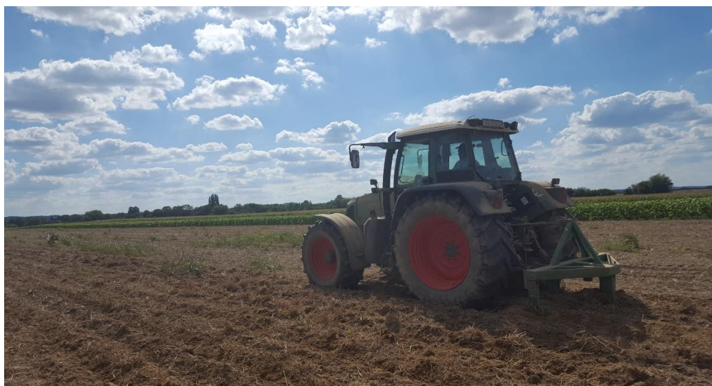
Slika 3.3 Podrivanje rovilom na dubinu od 40 - 45 cm
