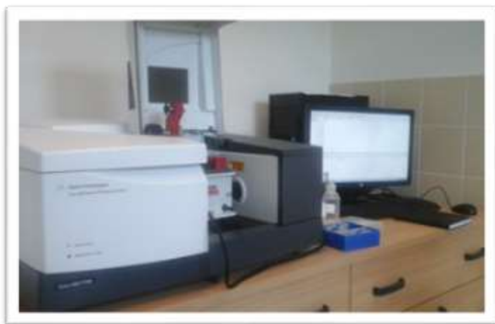
Slika 12. i 13. FTIR spektrometar (lijevo) s ATR instrumentalnim dodatkom (desno)
