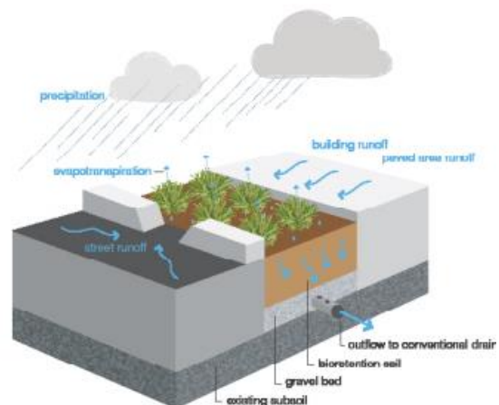
Slika 16. Presjek kišnog vrta u posudi Slika 17. Prikaz kišnog vrta na neporoznoj površini Izvor: Rain garden guide, https://raingardens.info/wp-content/uploads/2012/07/UKRainGarden-Guide.pdf - pristupano 9. lipnja 2019.
