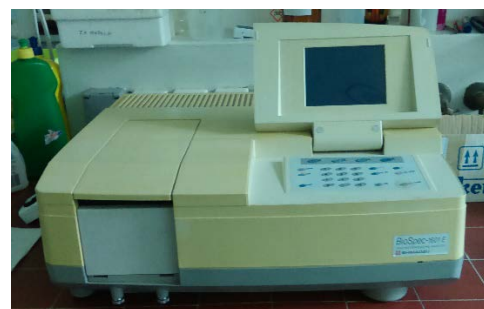
Slika 3.1.5. Shimadzu BioSpec-1601 E UV- Vis spektrofotometar
