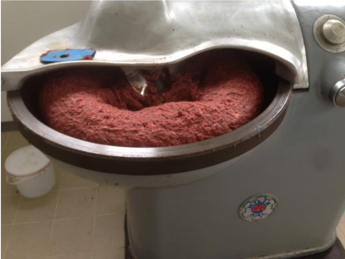
Slika 5: Usitnjena pripremljena smjesa sirovina za punjenje u konzerve u cuteru
