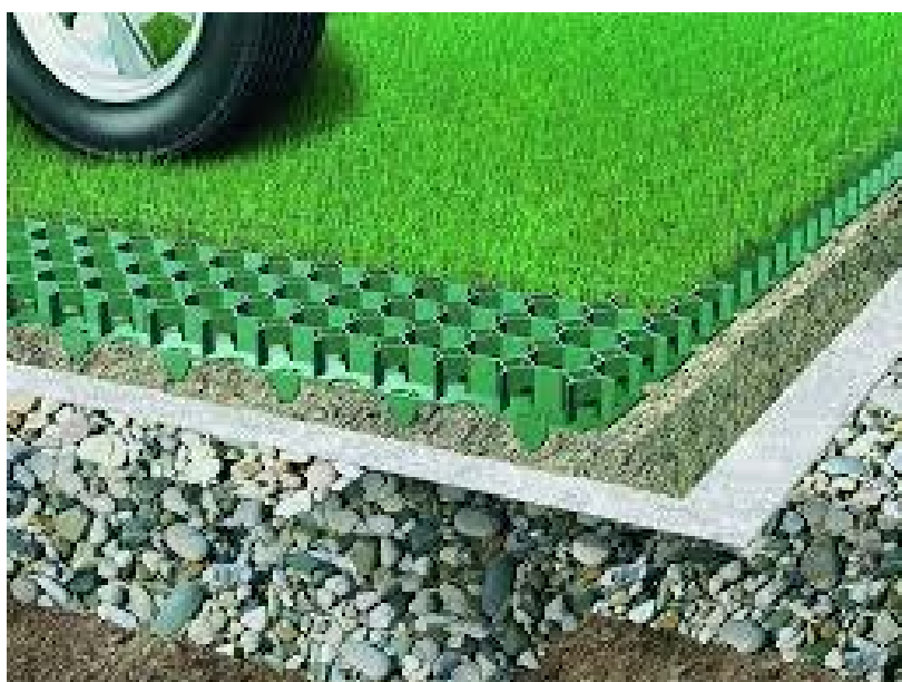
Slika 8. Prikaz travnate rešetke sa podzemnim slojevima (Izvor: https://drainforlife.eu/attachments/article/64/DFL%20SUDS%20Handbook%20final.pdf )
