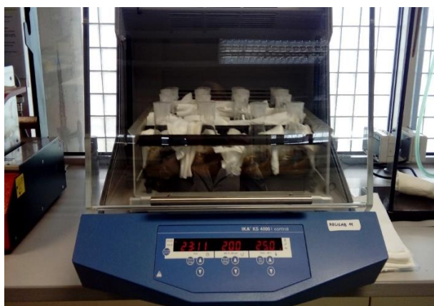
Slika 8. Uravnoteženje otopine tla u termostatirajućoj horizontalnoj tresilici
