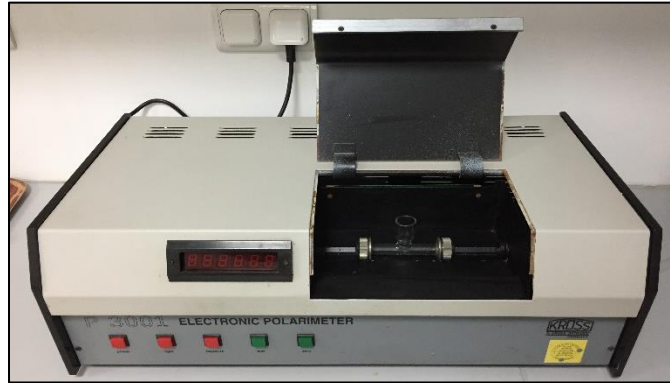
Slika 16. Polimetar za određivanje škroba (Izvor: Vlastiti)
