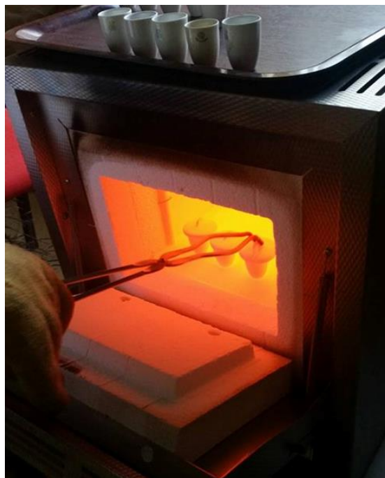
Slika 3.2.3.1: Određivanje sadržaja koksa u mufolnoj peći
