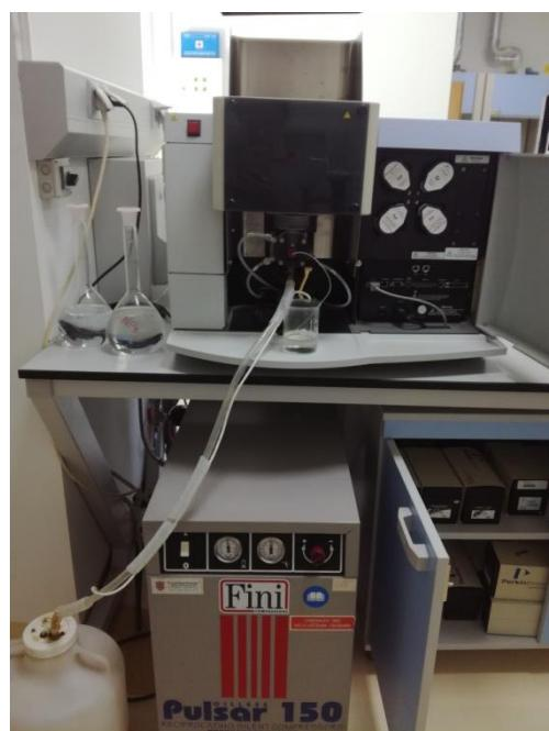
Slika 15. Atomski apsorpcijski spektrometar
