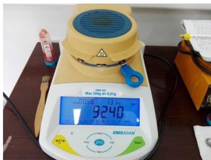
Slika 3.5.2.1. PMB 202 MoistureAnalyzer – uređaj za određivanje udia vlage u uzorku (Izvor: Martina Šarić)
