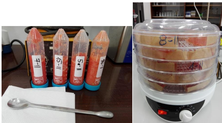
Slika 3.5.1.1. Kivete s osušanim i usitnjenim uzorcima ploda rajčice i sušionik (izvor: Martina Šarić)
