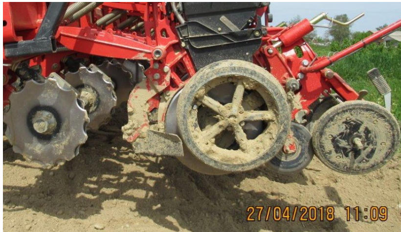
Slika 5. Dvostruki diskosni ulagač sjemena na sijačici (snimio Igor Kovačev)
