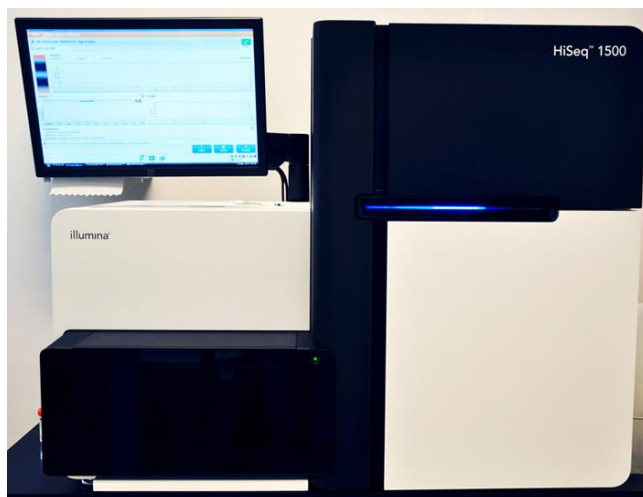
Slika 15. HiSeq 1500 uređaj za određivanje slijeda nukleotida druge generacije (CATG, 2014).
