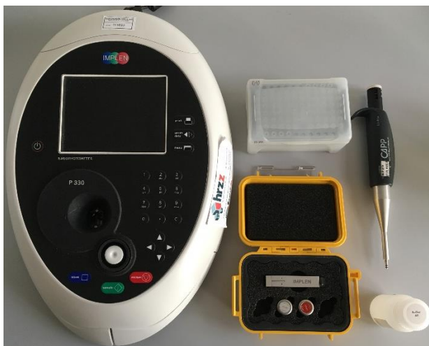
Slika 11. Uređaj NanoPhotometer P330 Spektrofotometer (IMPLEN, Njemačka) za mjerenje koncentracije DNA (Brajković, 2018).
