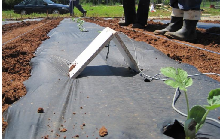
Slika 40. Mjerenje temperature 5 cm iznad tla i u tlu, 18. svibnja 2010.
